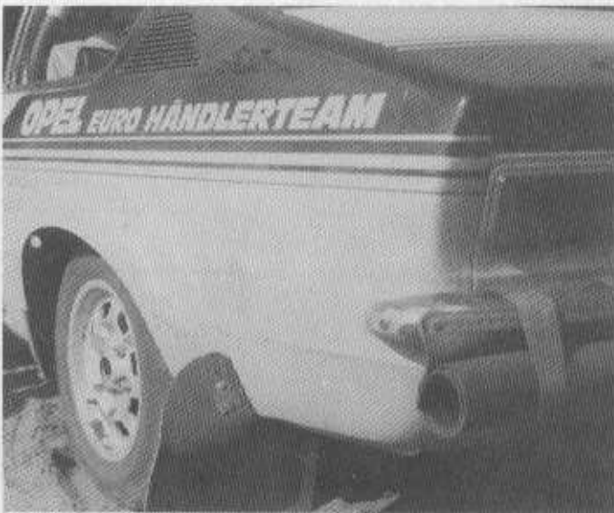
Riesige Schmutzfänger an den Stoßstangen (eigens für die Monte)
